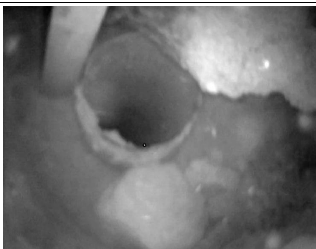
foto 8: Stav na dně vrtu v hloubce 49,5 m po odstranění kamene (zbytek dole). Překližková pažnice (uprostřed) uhnutá pod stěnu vrtu.
