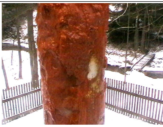
foto 6: Vytěžená antikoro výstroj z vnějšku, elektrochemicky vysrážené železo.
